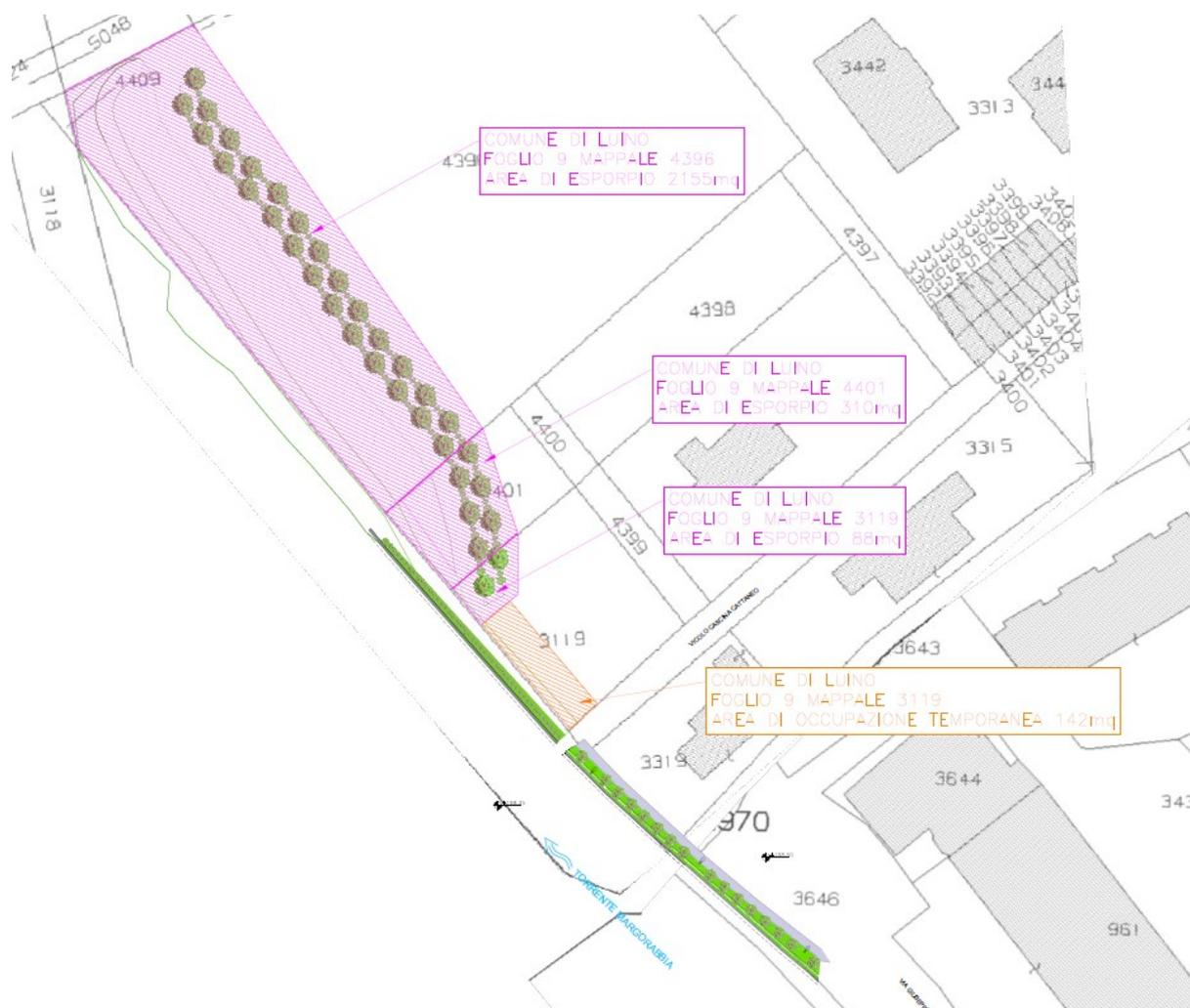
**Figura 25 – planimetria catastale con indicati i limiti dell'intervento in progetto**
